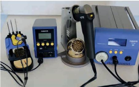
Hako LötKolben und Power-Entlöter
