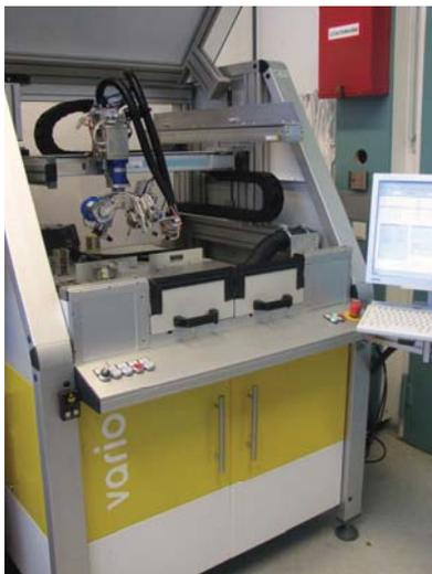
Abb. 3.3.3: Kolbenlötautomat /14/
