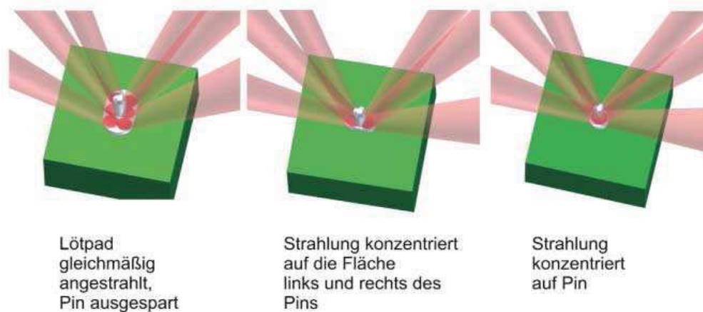
Abb. 3.3.2: Strahlformung mit Laserlötwerkzeug Typ LLW03 /13/
